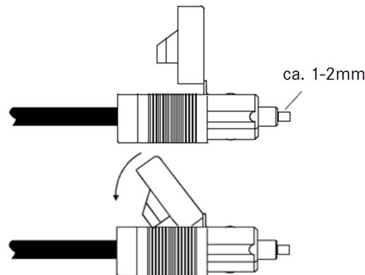
Durch Verpressen des Steckers wird die Faser im Steckverbinder gehalten.
